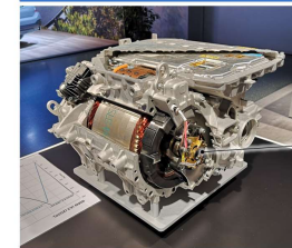
Integrierte Antriebseinheit von BMW für den iX3: Zum Einsatz kommt eine fremderregte Synchronmaschine. Im Zentrum der E-Maschine erhebt man das Schwingmodul.
